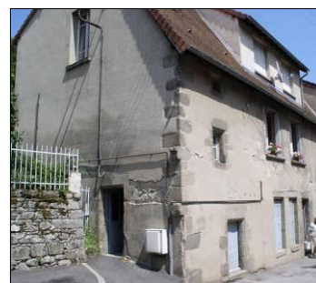
Maison rue Jean Jaurès. Vis dans – œuvre, située dans l'angle de la maison ; il desservait une maison voisine démolie. D'où deux portes sur la rue : à droite la porte d'entrée de la maison, à gauche une ancienne porte intérieure. La superstructure de l'escalier, qui devait s'élever au-dessus du toit, a disparu.
